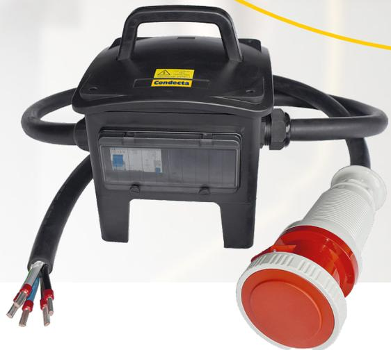
Le boîtier adaptateur FI portable avec prise CEE 125A protège les tableaux électriques de chantier grâce au disjoncteur différentiel de type B intégré et sensible à tous les courants (RCD). Cet adaptateur entièrement caoutchouté est résistant aux UV, aux acides et aux bases est conçu pour une utilisation intensive sur les chantiers.
