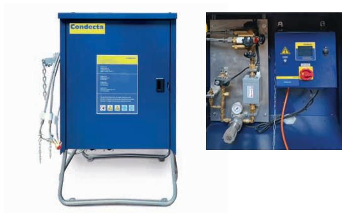
L'armoire de commande IPE se compose d'un coffret de distribution de chantier dans lequel sont logées la commande et l'alimentation en gaz. Deux bouteilles individuelles peuvent être fixées à l'armoire de commande IPE. La commutation de la réserve de gaz se fait manuellement. La mesure du pH dose automatiquement la quantité de CO<sub>2</sub> nécessaire pour atteindre le pH correct à la sortie de l'installation. Une lampe clignotante sur l'armoire de commande signale une valeur de pH trop élevée.
