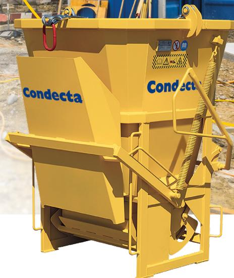
Benne à béton pour usage intensif avec écoulement central et latéral. La grande ouverture d'écoulement à levier sécurise et facilite le processus de déchargement. Peut être soulevée à l'aide de chaînes. Disponible en différentes tailles.
