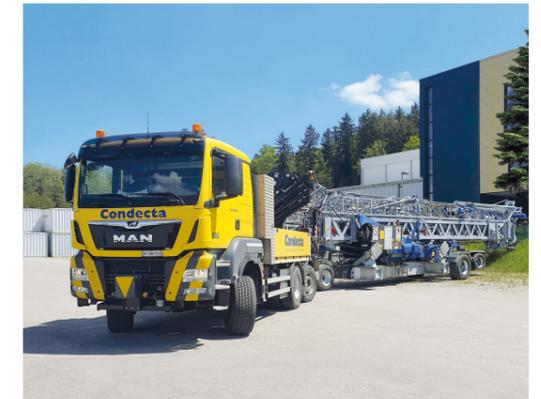
La grue à montage rapide EURO 4312, d'une portée de 43 mètres pour une charge principale de 5'000 kilogrammes, se caractérise par un travail précis et sans à-coups grâce à des entraînements à convertisseur de fréquence à commande électronique et à réglage continu, avec un courant de démarrage maximal de 40 ampères. Par ailleurs, sa hauteur sous crochet de 18 à 30 mètres peut être augmentée jusqu'à 24 mètres
