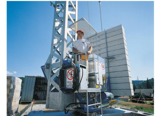
La grue à montage rapide EURO 3210, d'une portée de 32 mètres, se distingue par la construction de sa tour à polygones ouverts, qui lui confère une grande stabilité en torsion. Elle dispose d'un système moderne de montage pneumatique de la flèche, qui peut être commandé indépendamment de la sortie de la tour, ce qui constitue un avantage décisif, notamment dans les conditions de montage étroites et difficiles. De plus, la construction robuste du châssis infé-
