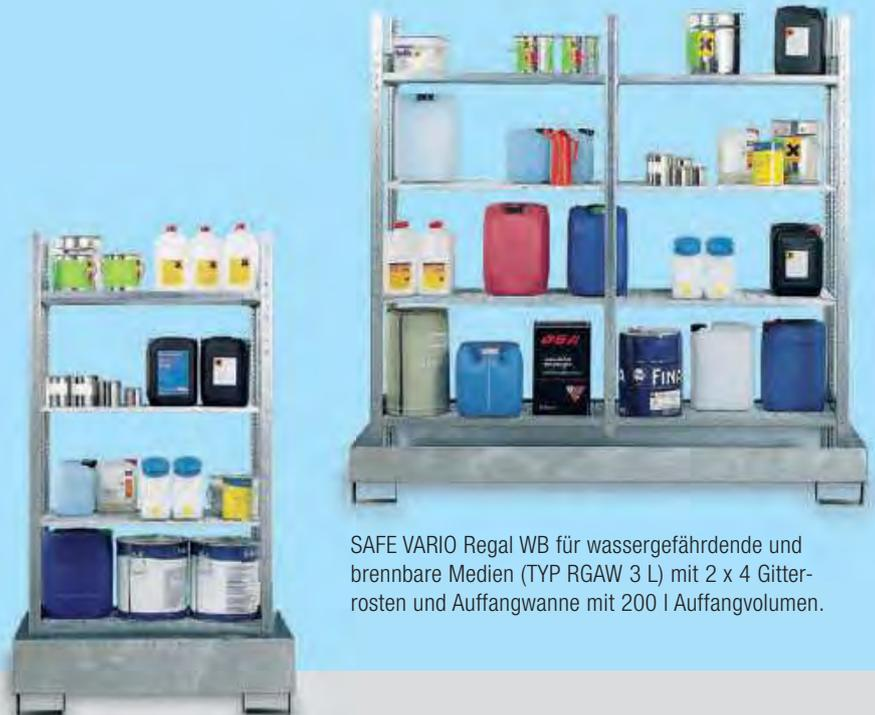
SAFE VARIO Regal WB für wassergefährdende und brennbare Medien (TYP RGAW 3 L) mit 2 x 4 Gitterrosten und Auffangwanne mit 200 l Auffangvolumen.
