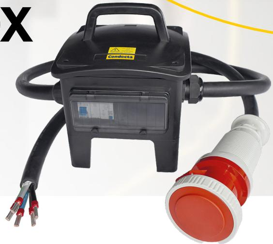
Die tragbare FI-Adapterbox mit CEE-Kupplung 125A schützt Baustromverteiler dank des integrierten allstromsensitiven Typ B Fehlerstromschutzschalter (RCD). Der vollgummierte Adapter ist UV-, säure- und laugenbeständig und für den harten Einsatz auf Baustellen konzipiert.
